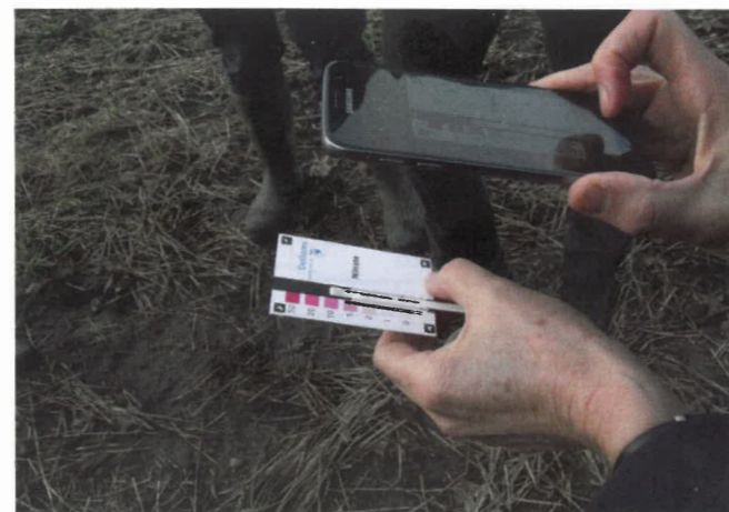
Nitratstrips dyppes i drænvandet i et sekund, og så scanner man farven på strip'sen via en app på sin telefon, og får en hurtiganalyse af nitratindholdet.
